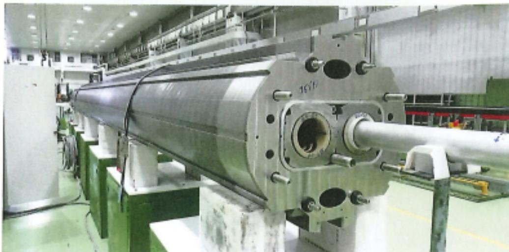
b. Prototipo di lunghezza ridotta dei dipoli superconduttori necessari ad aumentare la luminosità di Lhc (Lhc Hilumi), durante la fase di test presso la Asg Superconductors (Genova). I nuovi dipoli saranno realizzati con un nuovo materiale, il niobio3-stagno, mai impiegato finora nella costruzione di acceleratori, ma che permette di raggiungere una corrente elettrica, e dunque un campo magnetico, più intensi rispetto alla lega niobio-titanio finora utilizzata.
