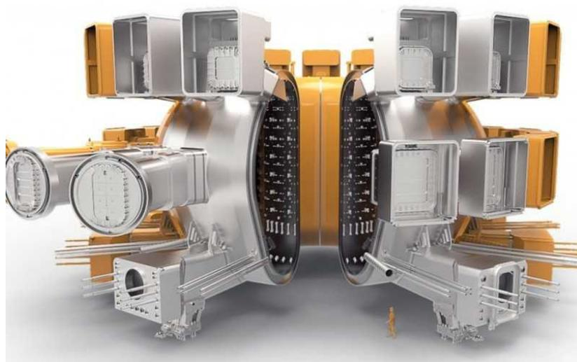
Più facile a dirsi che a farsi però: per fondere i due isotopi è necessario **creare un plasma**, un gas ad altissima temperatura (100-150 milioni di gradi) – che è uno stato della materia vero e proprio. Non è una cosa che si possa mettere in un contenitore qualsiasi ed ecco perché sono necessari i giganteschi magneti prodotti (anche) in Italia. Si parla infatti di **confinamento magnetico** proprio perché è questo tipo di energia a tenere il plasma in posizione.
