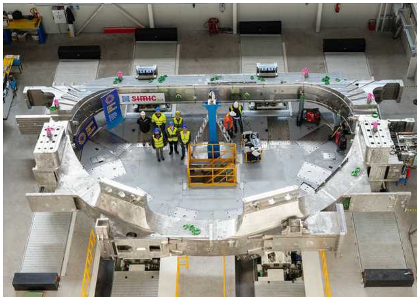
Completato il primo supermagnete italiano destinato al reattore ITER (fonte: SIMIC, F4E) © ANSA/Ansa
